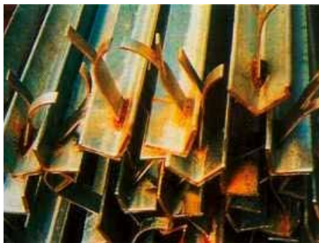
Ill. 18 : Défauts au niveau de la couche de zinc en raison de laitier non éliminé
